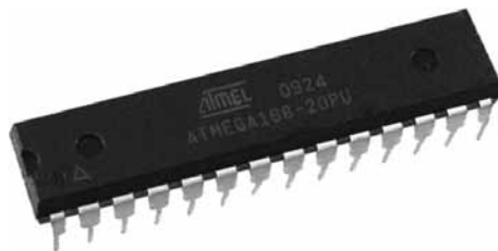
Figura 1.24 – Chip Atmel ATmega, o coração do seu Arduino (imagem cortesia da Earthshine Electronics).
