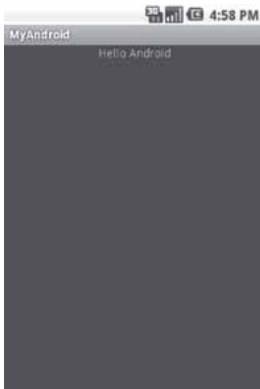
Figura 1.7 – Projeto Eclipse sendo executado no emulador.
