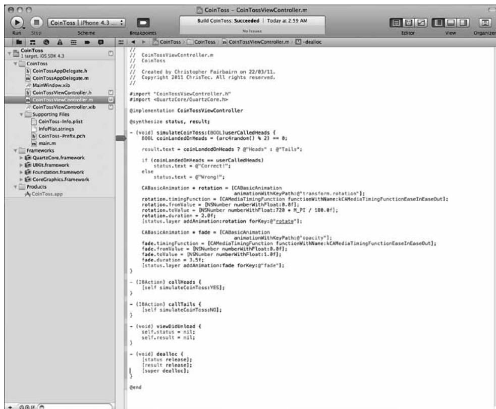
Figura 1.13 – Definição de um breakpoint para uso pelo depurador sempre que a primeira linha do método simulateCoinToss: for chamada. Note a presença do marcador na margem, indicando um breakpoint ativo.
