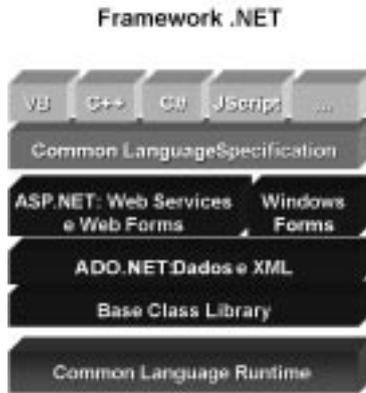
Figura 1.1 – Visão geral dos elementos do Framework .NET.
